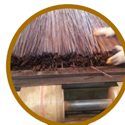
modyfikacja termiczna włókien w temperaturze 200°C
